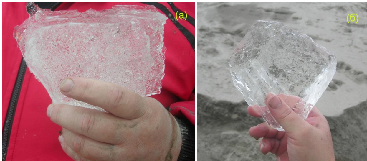
Рис. 5. Структурно-текстурные особенности пластового льда, р.Еркутаяха: а – лёд чистый матовый белый с большим количеством газовых ксеногенных включений; б – лёд “хрустальный” прозрачный
