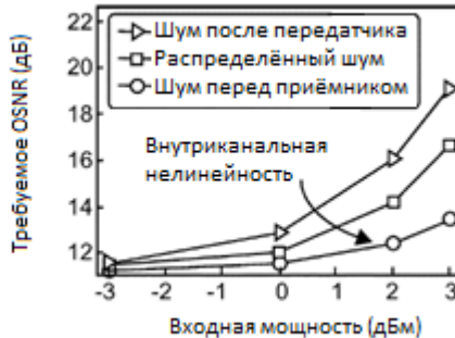
Рис. 10.14. Влияние нелинейного фазового шума на величину OSNR при одноканальной передаче сигнала 42.7 Гбит/с в формате 50% RZ-DPSK. Параметры линии: 32 участка по 80 км, D = 4.5 пс/(км·нм), S = 0.045 пс/(км 2 ·нм), \alpha = 0.2 дБ/км, n_2 = 2.5 \times 10^{20} м 2 /Вт, и A_{eff} = 52.86 мкм 2 . Пространственное распределение дисперсии одно-периодическое, предварительная компенсация = -250 пс/нм, остаточная дисперсия каждого участка = 20 пс/нм и остаточная дисперсия = 20 пс/нм.
