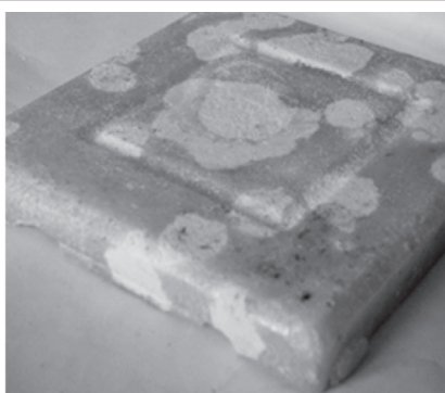
Через 18 ч после плавления доля полисульфидов — 3,1%
