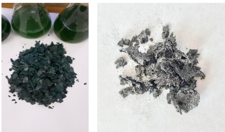
Рис. 4 – Исходная биомасса МКВ (слева) и угольный остаток после пиролиза (справа)
