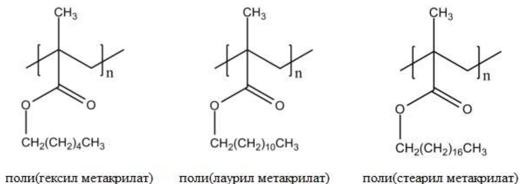
Рисунок 1. Химические структуры исследованных полиалкилметакрилатов.
