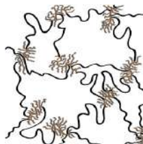
Рисунок 1. Схематичное изображение полимерной матрицы с боковыми цепями.
