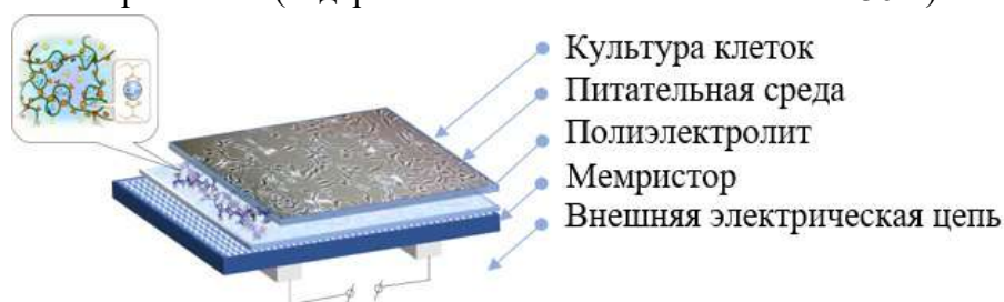
Рисунок 1. Схема биофункционализации мемристивного элемента
