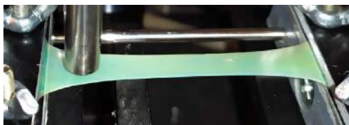
Рисунок 1. Фотография образца композита на основе холестерика, диспергированного в полисилоксановой матрице. Хорошо видно селективное отражение света в зелёной области спектра.
