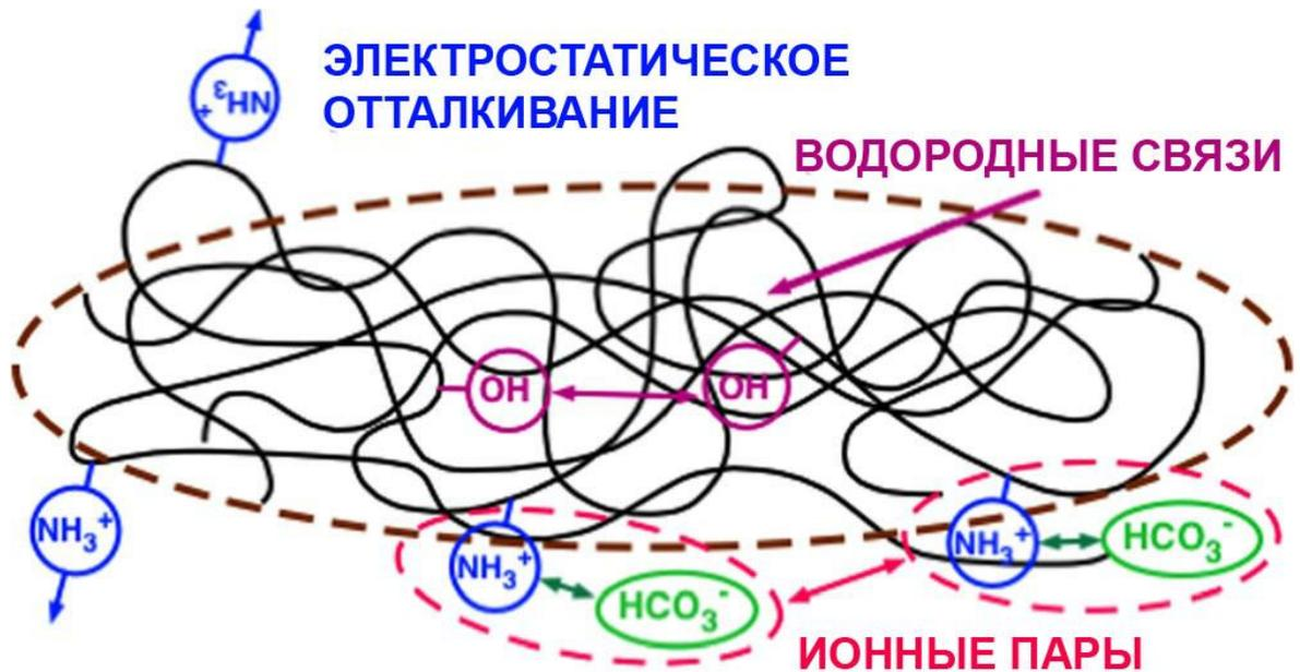
Рисунок 2.10 – Схематичное изображение вытянутой глобулы, состоящей из нескольких макромолекул хитозана.
