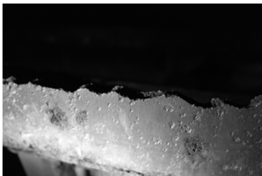
Рис.4. Коррозионно-эрозионное изнашивание кромки лопасти перемешивающего устройства
