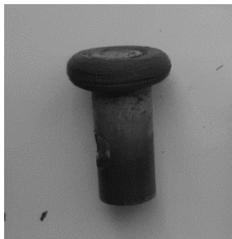
Рис. 4. Разорвавшийся медный образец из-за излишней маховой массы
