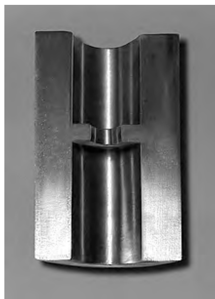
Рис. 5. Срез выдавленного образца из стали 12Х18Н9Т
