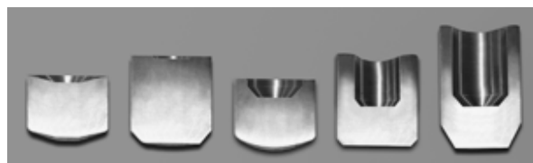
Рис. 4. Срезы выдавленных образцов из алюминия АД1
