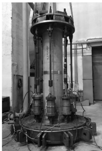
Рис. 1. Общий вид сборки из труб DN 718 SN 128000 из двух образцов по 1500 мм с фрезерованными частями под муфту, соединенных стальной муфтой между собой в испытательном стенде.
