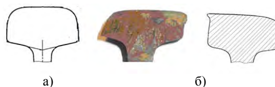
Рис. 2. - Поперечные сечения нового (а) и изношенного (б) рельсов.
