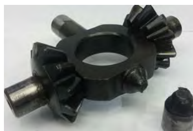
Рисунок 4. Внешний вид разрушения шипа крестовины после испытаний
