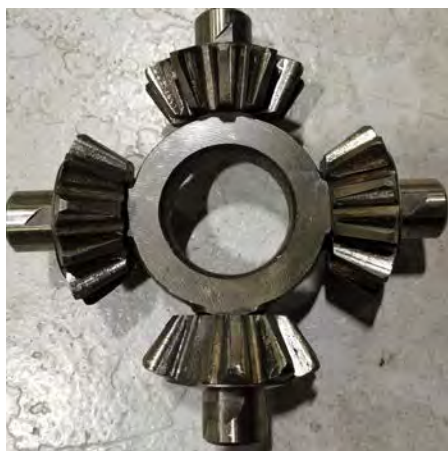
Рисунок 1. Крестовина и сателлиты межосевого дифференциала
