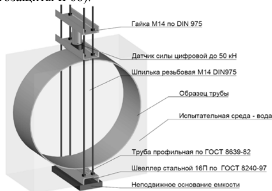
Рис.2. Схема стенда для испытаний.
