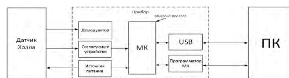
Рис.3. Функциональная схема измерителя угла поворота \theta
