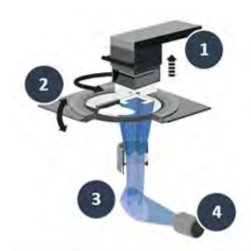
Рис. 1. Принципиальная схема LCM-технологии компании Lithoz: 1) – платформа построения; 2) – ванна с суспензией; 3) – оптическая система; 4) – LED-проектор
