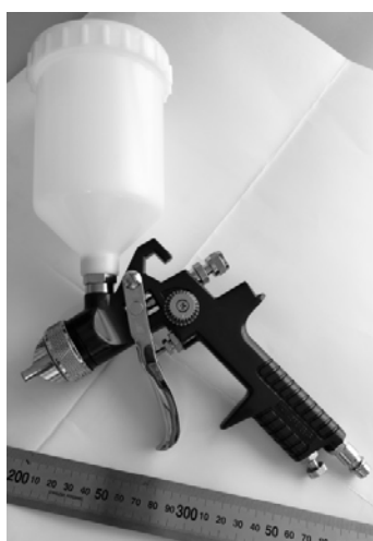
Рис. 1. Пневматический распылитель для нанесения покрытий Константа А
