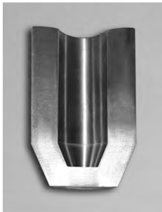
Рис. 6. Срез выдавленного образца из стали 12Х18Н9Т
