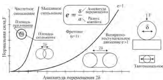
Рис. 1. Различные ситуации при скольжении шарика по плоскости
