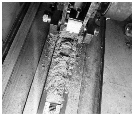
Рис. 3. Образцы, покрытые пескобетоном
