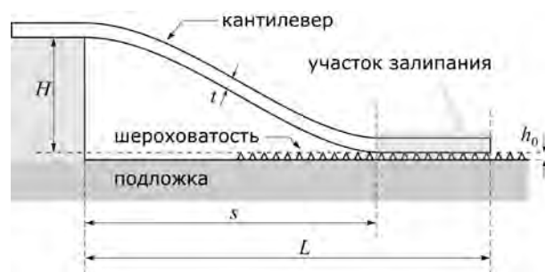
Рис. 1. Схема метода залипшего кантилевера
