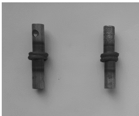
Рис. 3. Сваренные детали. Ст3-Ст3 (слева), Ст3-Ст45 (справа)
