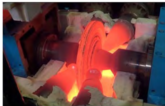
Рис. 6. Раскатка заготовки в нагревательной печи
