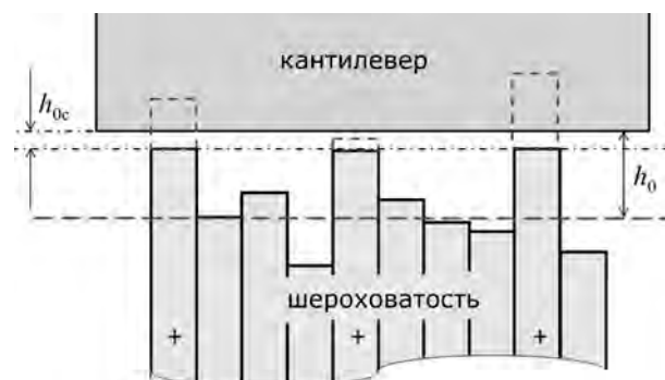
Рис. 4. Модель контакта кантилевера и шероховатой подложки. Знаком «+» помечены неровности, находящиеся в состоянии пластического течения
