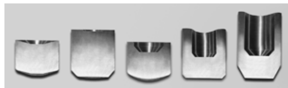
Рис. 5. Срезы выдавленных образцов из латуни Л63
