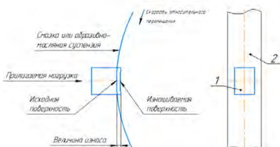
Рисунок 2 - Схема испытаний на изнашивание в условиях трения скольжения: 1- исследуемый образец; 2- контрольный образец.
