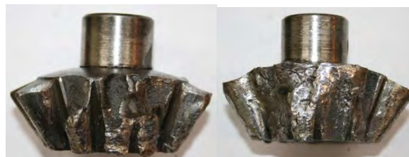
Рисунок 3. Вид разрушенной детали с прикипевшим сателлитом и шипом крестовины
