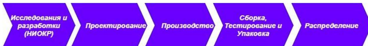
**Рисунок 40 - Стадии производства полупроводниковой аппаратуры**
