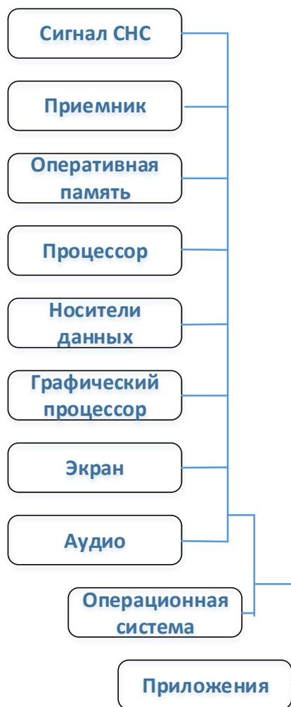
**Рисунок 19 - Архитектура навигационной аппаратуры: устройство на полупроводниках и программное обеспечение.**
