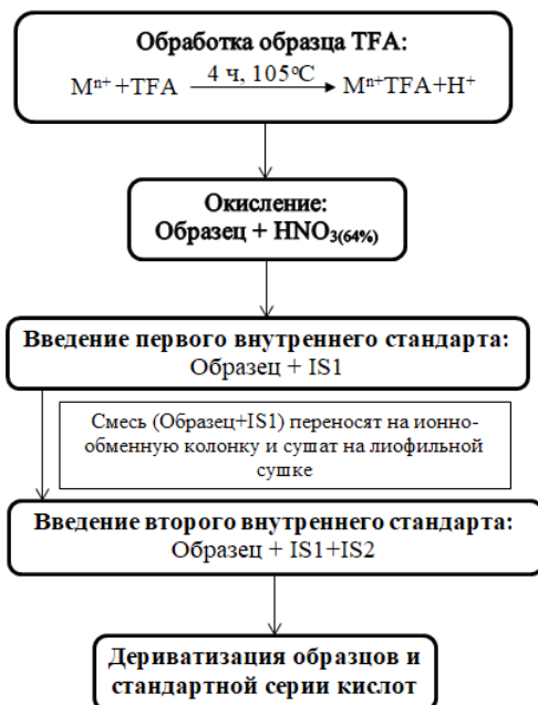
Рисунок 2 – Схема проведения анализа по методу Гласера
