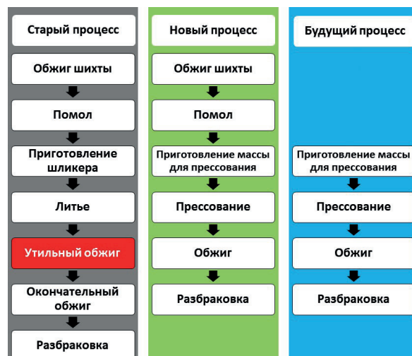
Рис. 3. Изменение технологии изготовления ФП
