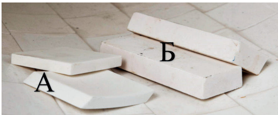
Рис. 4. Наглядное сравнение формы и размеров ФП: А – «старые» тонкостенные; Б – «новые» толстостенные
