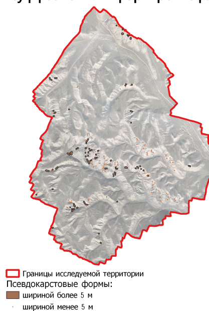
Рис. : Схема дешифрирования псевдокарстовых и суффозионных форм рельефа
