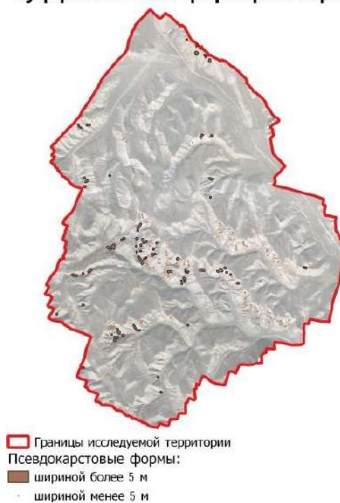
Рис. 4. Схема дешифрирования псевдокарстовых и суффозионных форм рельефа
