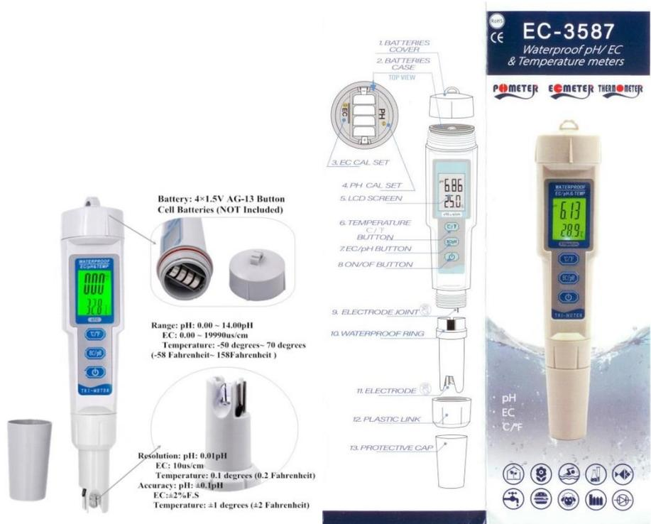
**Рис. 7.** Внешний вид прибора EC-3587 и схема устройства. 1 – крышка отделения для батареек, 2 – отделение с батарейками (4×1.5V AG-13), 3 – винт калибровки ЕС, 4 – винт калибровки рН, 5 – LCD экран, 6 – кнопка выбора температурной шкалы (°C/F) 7 – кнопка выбора параметра ЕС/рН, 8 – кнопка вкл/выкл, 9 – передающий электрод, 10 – влагозащитное кольцо, 11 – электроды, 12 – соединительное кольцо, 13 – защитная крышка.
