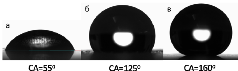
Рис.1. Краевые углы смачивания на исходной поверхности сплава 1580 (а), после нанесения покрытия теломеров ТФЭ (б), после механического удаления верхнего слоя покрытия (в)
