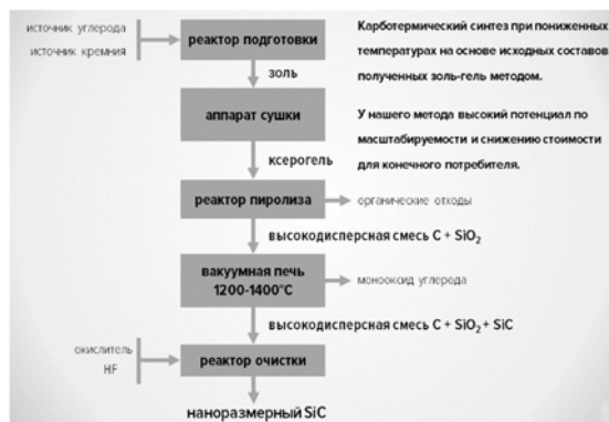
Рис. 1. Схема синтеза nano-SiC.
