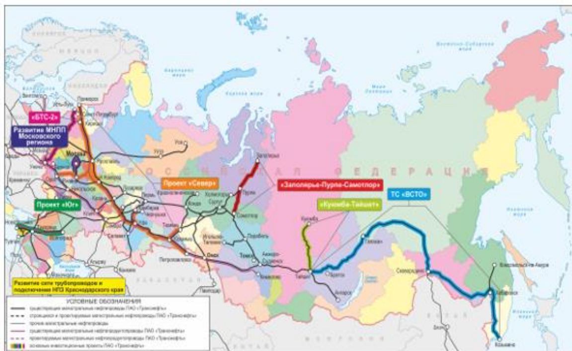
Рисунок 51 Схемы магистральных трубопроводов ПАО «Транснефть». [15]
