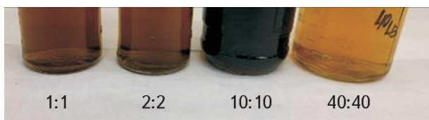
Рис. 3. Фильтраты КЖ, полученной при культивировании S. oneidensis MR-1 в LB среде, содержащей различные концентрации каждой из солей \text{AgNO}_3 и \text{Na}_2\text{S}_2\text{O}_3 , mM: 1, 2, 10 и 40
