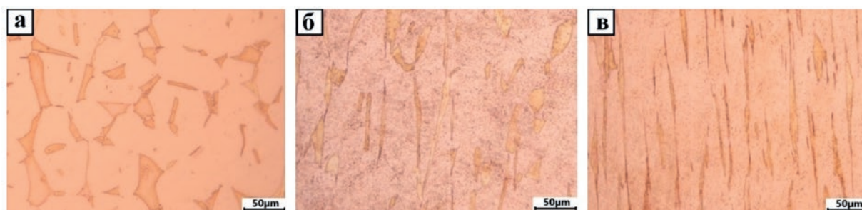
Рис. 1. Структура латуни Л63 после закалки (а), РК при \varepsilon = 0,91 (б), \varepsilon = 2,31 (в)
