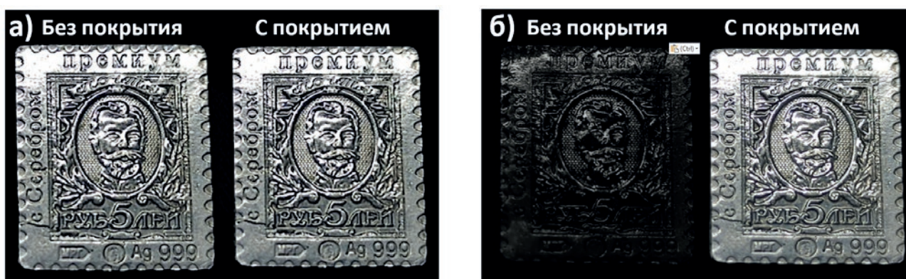
Рис. 1. Результаты выдержки серебряных жетонов с защитным покрытием и без защитного покрытия в агрессивной среде: (а) до погружения в раствор серы, (б) после выдержки в растворе серы.
