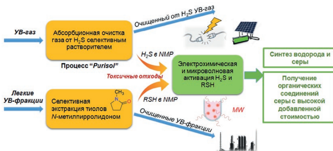
Рис. 1. Схема утилизации серосодержащих отходов малотоннажных нефтегазовых производств
