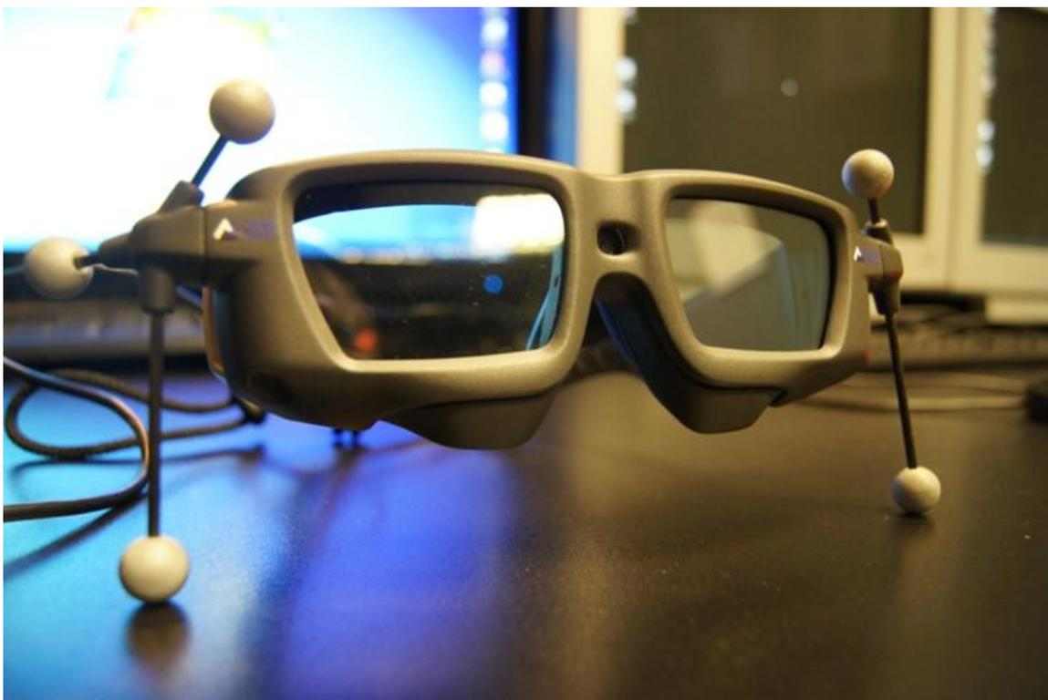
**Рис.9. Система регистрации движений глаз SMI Eye Tracking Glasses**
