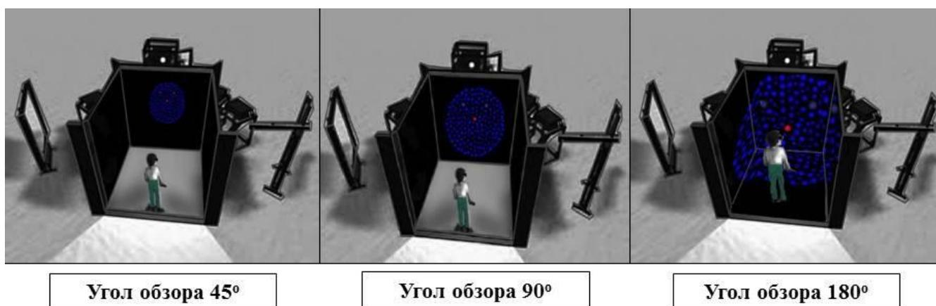
**Рис. 10. Схематические изображения стимуляции, предъявляемой в трёх условиях эксперимента в установке виртуальной реальности CAVE-system**
