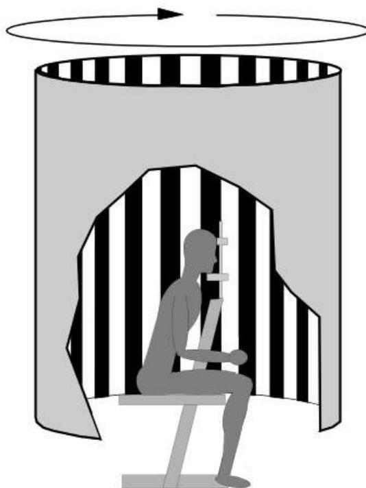
**Рис. 1. Схема одной из первых экспериментальных установок, которую использовали М. Фишер и А. Корнмюллер при изучении иллюзии движения собственного тела. Человек помещается внутрь полого цилиндра - оптокинетического барабана. Стрелкой показано направление вращения цилиндра вокруг испытуемого (по Schulte-Pelkum, 2013).**
